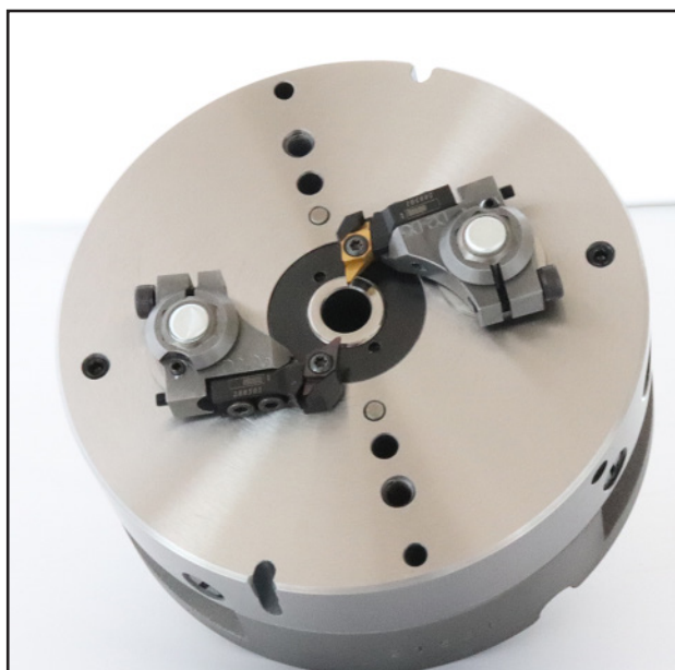
Cabezal Ventura convertida D2 120 con eje hexagonal
