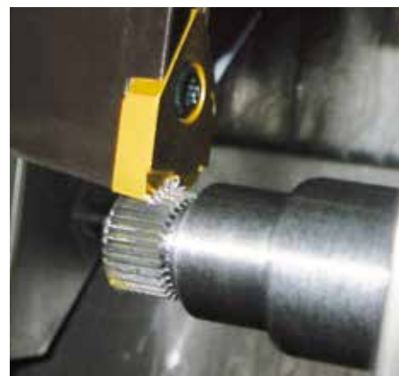
施瓦诺克刀具和采用齿形刀具加工车削件。
