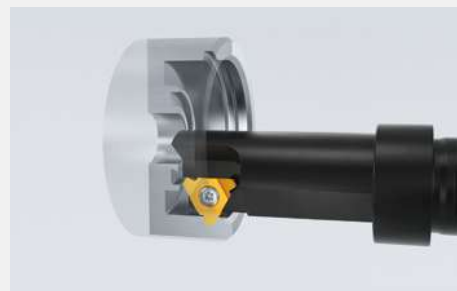
Scanalatura interna radiale e assiale
